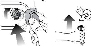
3. Nach dem Anschluss der Schläuche öffnen Sie die Wasserzuleufe (Hähne) komplett und überzeugen sich davon, dass kein Wasser an den Anschlussstellen austritt. Falls Wasser austreten sollte, drehen Sie den Hahn zu und lösen anschließend die Mutter. Überprüfen Sie die Dichtung und ziehen Sie die Mutter anschließend wieder gut an. Um ein Auslaufen von Wasser und daraus entstehende Wasserschäden zu vermeiden, halten Sie die Wasserhähne geschlossen, wenn Sie die Maschine nicht benutzen.
